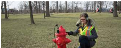
ÉTAPE 1 : FIXEZ LE CAPTEUR SUR LES POINTS DE CONTACT EXISTANTS DE LA CANALISATION.
