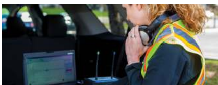
ÉTAPE 4 : DES ALGORITHMES INFORMATIQUES ANALYSENT LES DONNÉES POUR DÉTERMINER L'ÉTAT DE LA CONDUITE.
